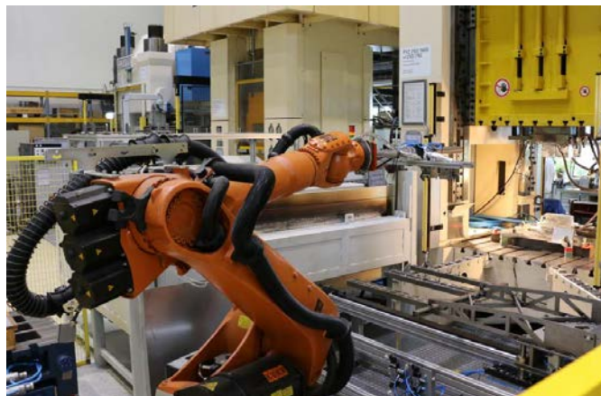
Abb. 2 Presshärteprozess bei der Blechbearbeitung am Fraunhofer IWU in Chemnitz. Die Maschinendaten werden ausgewertet, um den Prozess durch ML noch effizienter zu gestalten.
